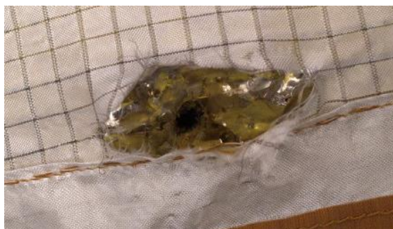
Рисунок 1. Фрагмент повреждённой обшивки международной космической станции
