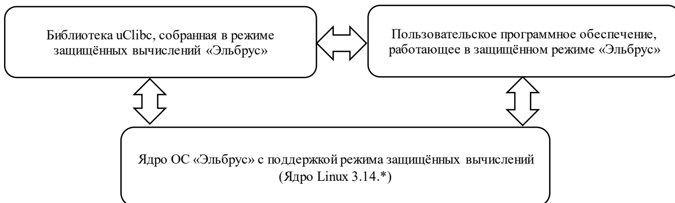
Рисунок 1. Краткая структурная схема дистрибутива для встраиваемых систем с поддержкой защищённого режима
