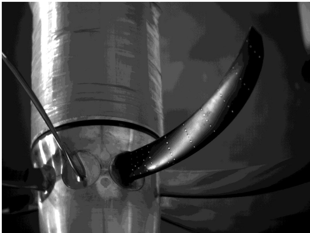
Рисунок 4 Рабочее изображение ротора воздушного винта с рабочей лопастью в положении измерения
