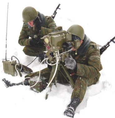
Рис. 1 – Расчет с лазерным целеуказателем-дальномером ЛЦД-4.
