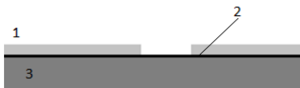
Рисунок 2. 1 - слой резиста, 2 – слой алюминия, 3 – стеклянная подложка
