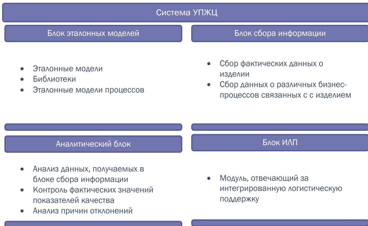
Рисунок 2.3 - Состав СУПЖЦ и задачи блоков СУПЖЦ
