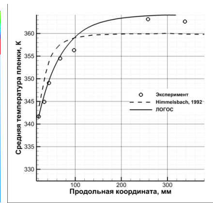
Рис. 2. Средняя температура пленки в зависимости от расстояния вдоль трубки
