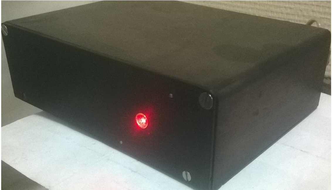
Рис.3 Общий вид гетеродинного фотоприемника ФПГ установки для измерения зависимости изменения разности частот от времени нагрева
