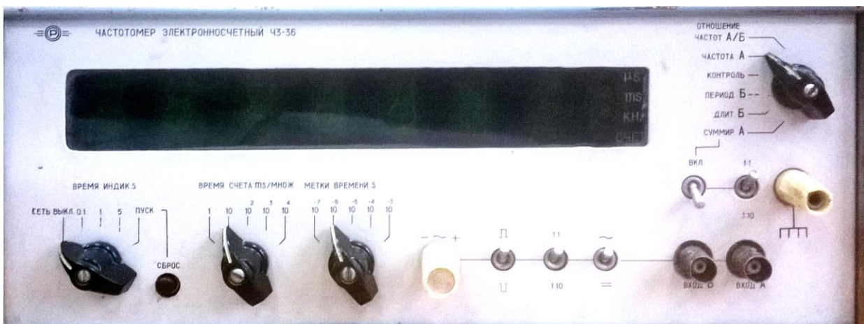
Рис.6 Процесс измерения зависимости разности частот от времени нагрева с использованием частотомера ЧЗ-36
