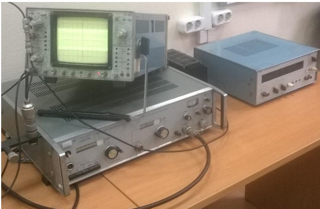
Рис.4 Общий вид осциллографа С1-83 и частотомера ЧЗ-36 установки для измерения зависимости изменения разности частот от времени нагрева
