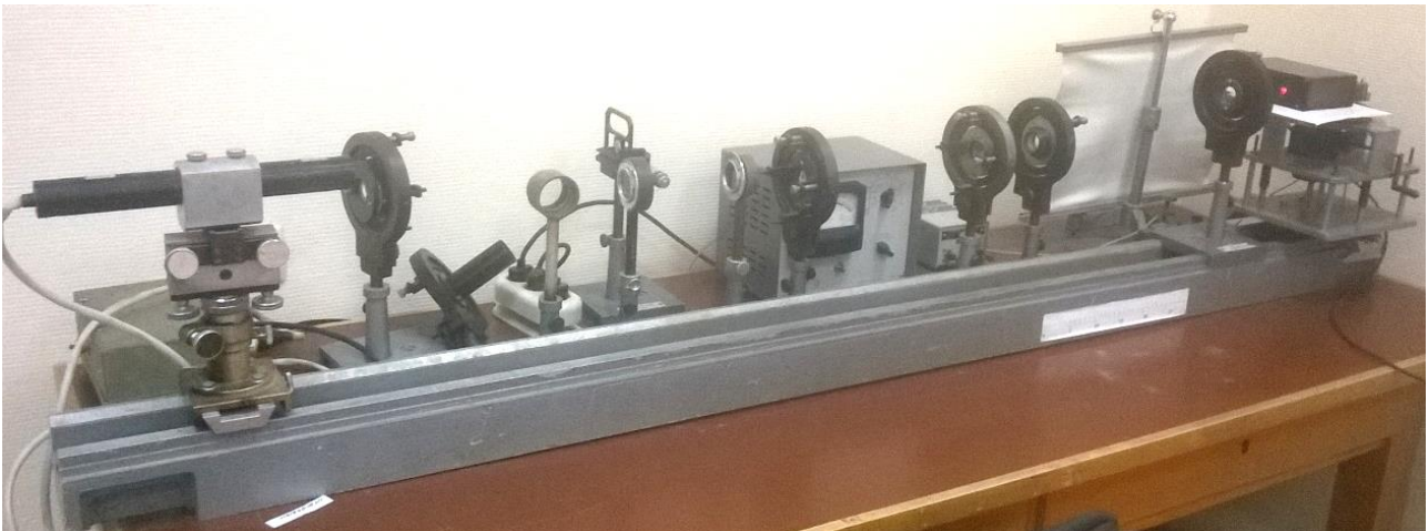
Рис.2 Общий вид измерительной установки: лазер ЛГН-207, блок питания БП2, линза Л, гетеродинный фотоприемник ФПГ и блок питания БП1
